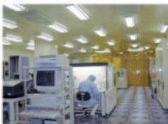
산업용 크린룸 (Industrial Clean Room)은 반도체 산업 뿐만이 아니라 정밀기기, 광학기기, 자기테이프, 사진용 필름, 인스린트 식품의 제조와 포장, 특수인쇄 등에 이르기 까지 폭넓게 사용되며, 요구되는 청정도 또한 각각의 공정에 따라 상이하게 구분됩니다. 그리고 Clean Room 은 외부로부터 진에 입자 등을 유입시키지 않기 위하여 시설 전체를 오염구역, 준청결구역, 청결구역으로 구성할 필요가 있습니다. 그리하여 이 구역간에는 AIR SHOWER나 PASS BOX를 통한 출입을 하여 공간과 공간사이에 공기의 유통을 막으며 각 공간에는 공기의 역류등을 방지하기 위하여 DAMPER를 사용하여 효율적인 청정도 유지를 기하여야 합니다.
